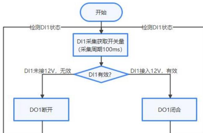
10、设备重启后，联动事件生效，可以通过 DI1 接通 12V 或断开 12V 电源，来观察 DO1 的动作。
