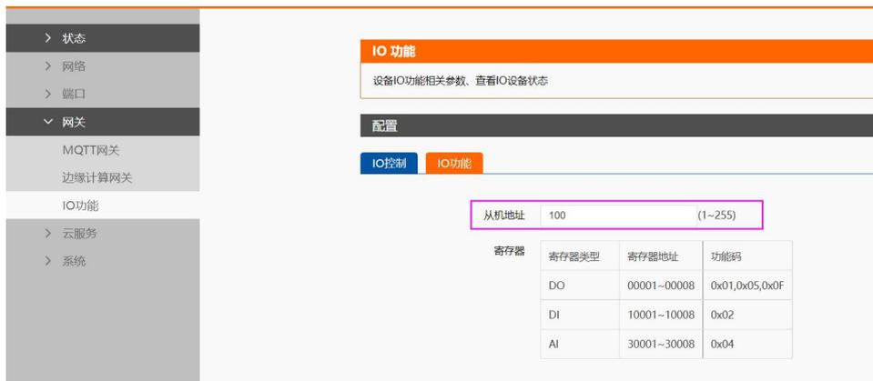
M100 自带内置 web 调试界面，方便客户直接控制 DO 和获取 DI，AI 的采集量。
