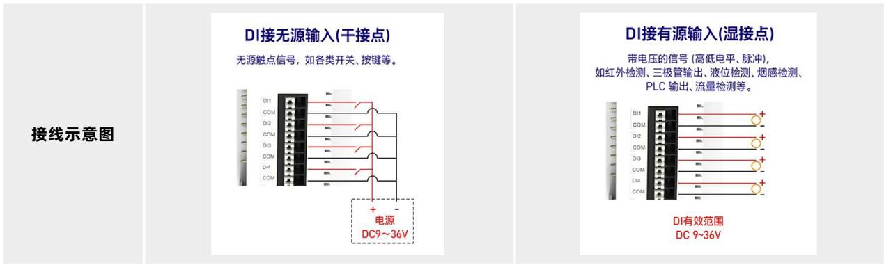
**检测模式:** M100 的 DI 可以检测开关量输入, 9-36V 为高 (状态置 1), 0-2V 为低 (状态置 0)。
